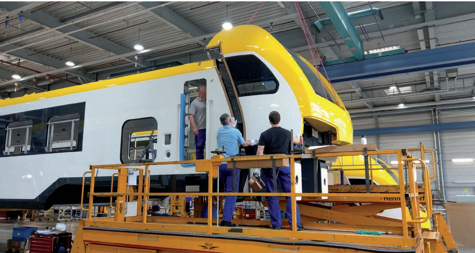
Die Bugmaske wird auf einen Wagenkasten montiert.
