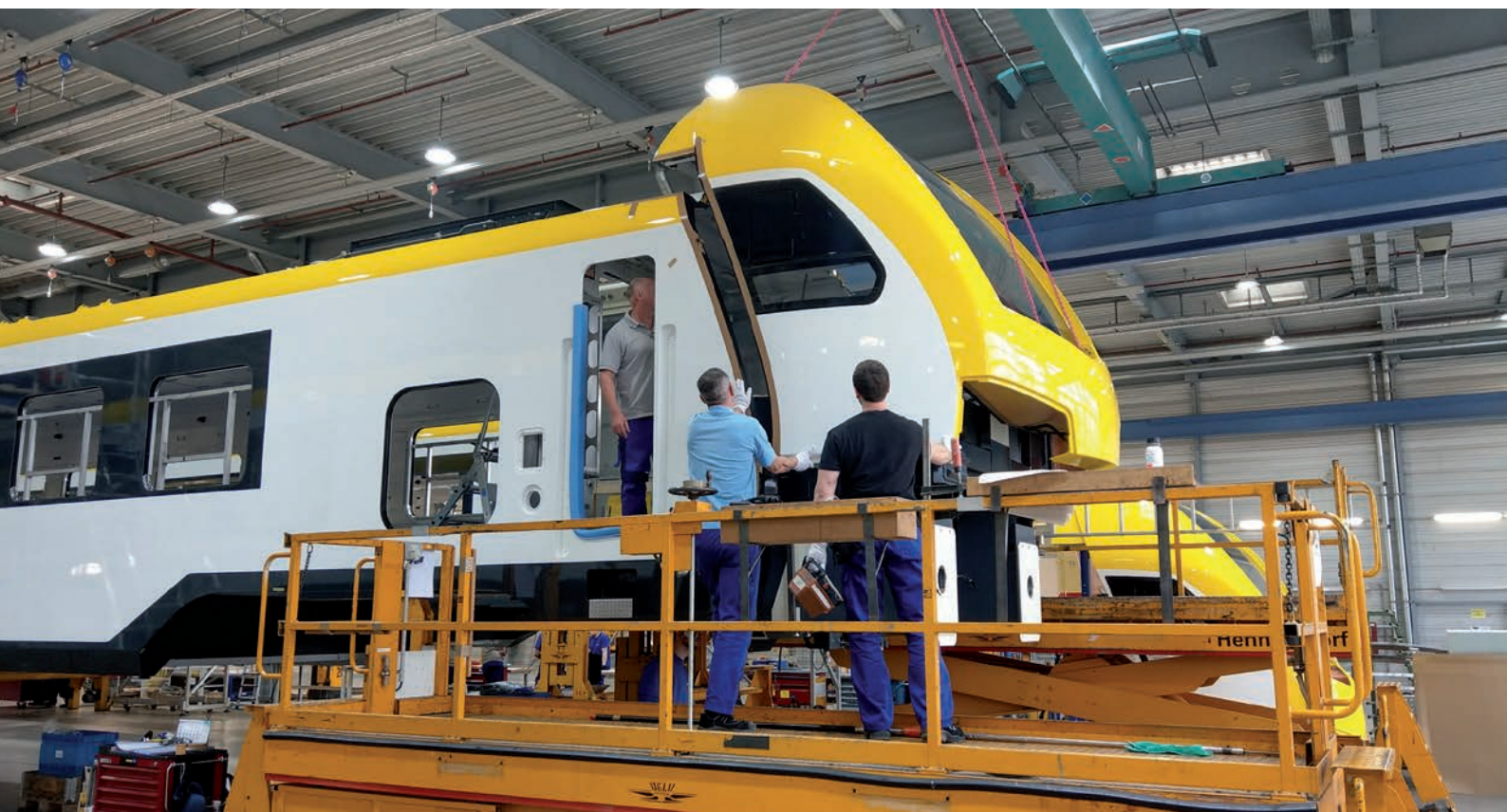
Die Bugmaske wird auf einen Wagenkasten montiert.
