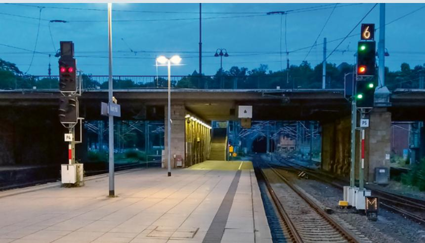
Ausfahrsignal erlaubt die Abfahrt mit 60km/h
